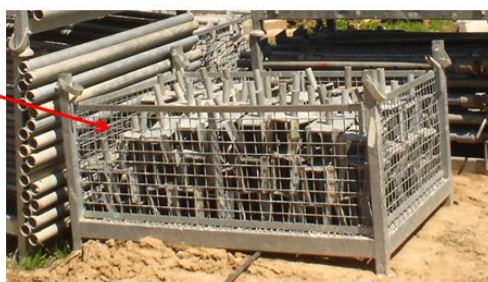
Casier pour stockage des fourches d'étais
