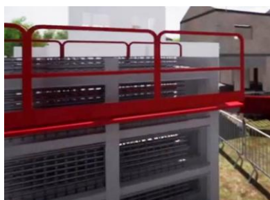
Casier pour stockage des fourches d'étais
