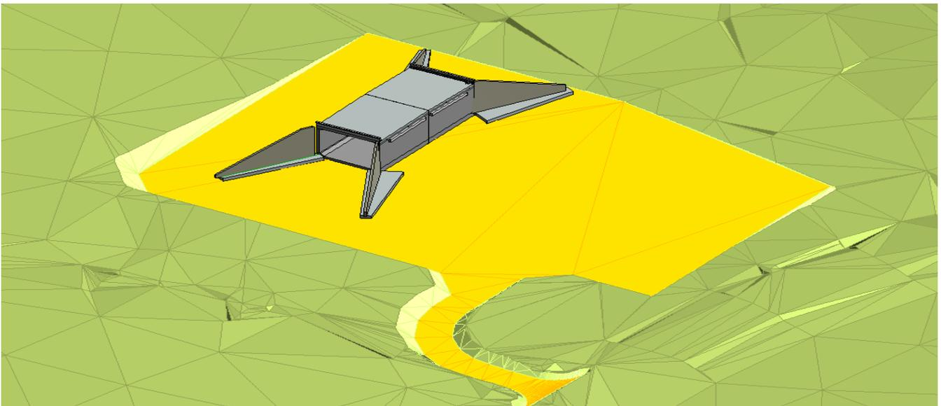
Modélisation 3D de la plate-forme de terrassement, lié à la maquette numérique de l'OA 450 réalisée en partie 1
