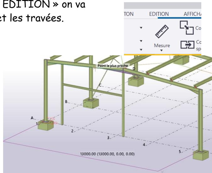
On obtient 13m entre long-pans et 6m entre travées.
