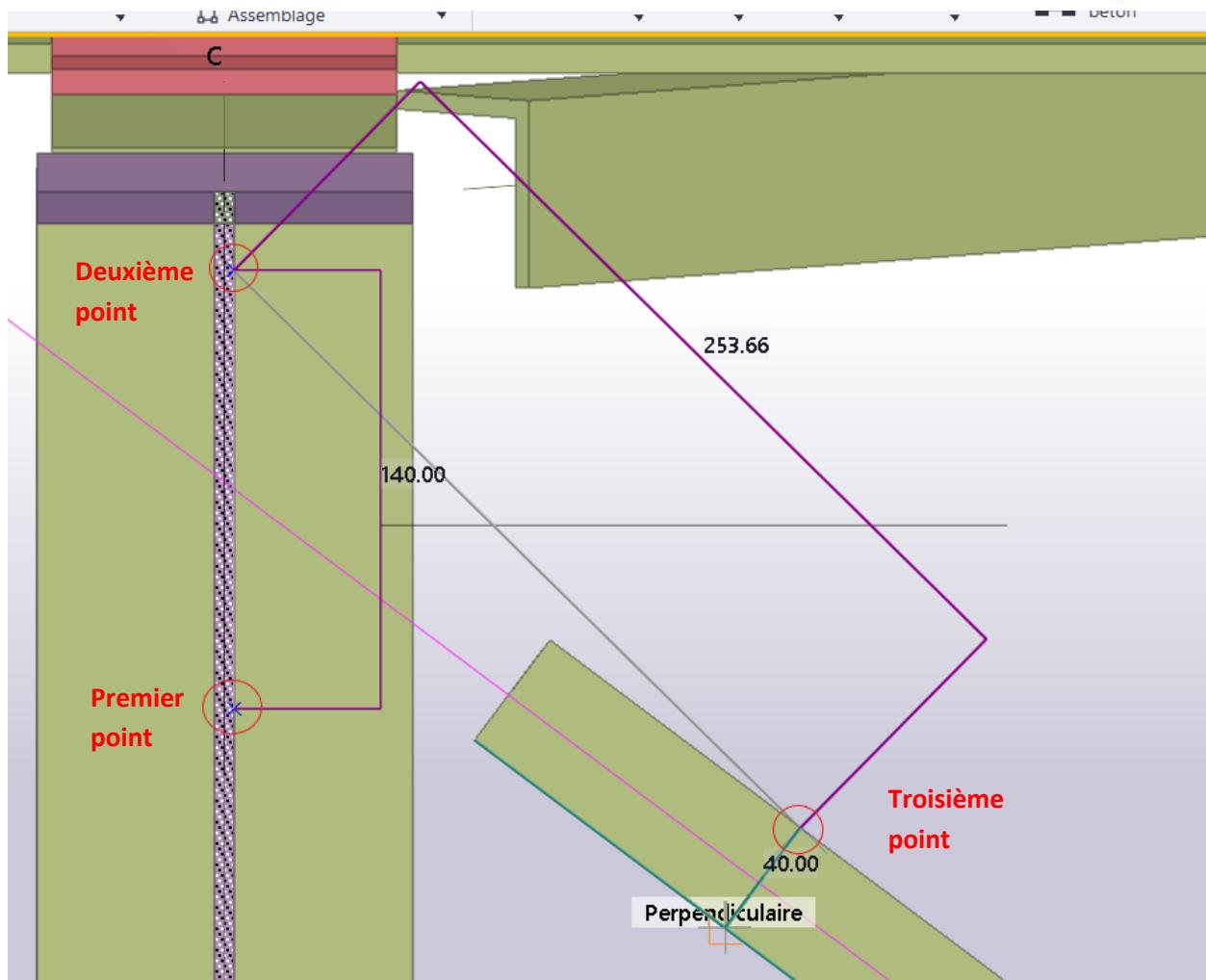
Le quatrième point se matérialisera grâce à l'accrochage « Perpendiculaire » (vérifier que l'onglet soit coché).
