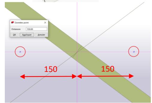
Avec la fonction « Points » « Par deux points », délimiter le contour d'un carré de = 300
