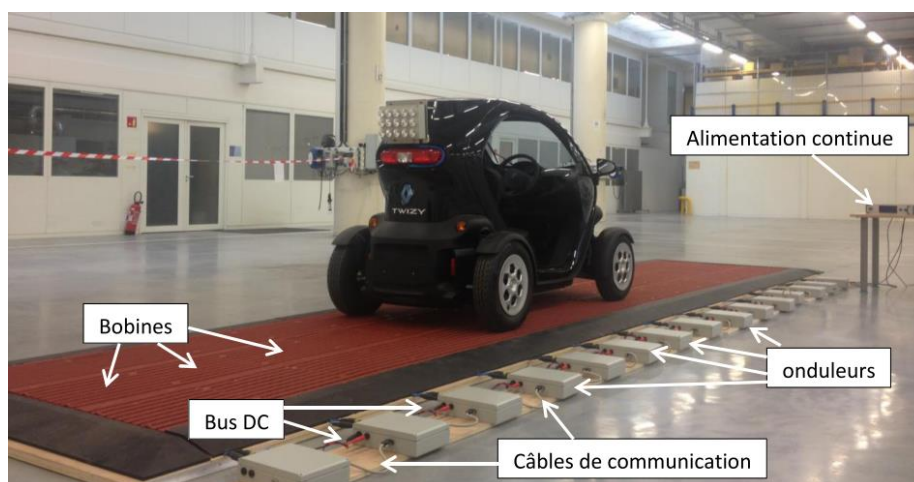
Figure 8 : Système DWPT développé par Renault-Supélec, source [5].
