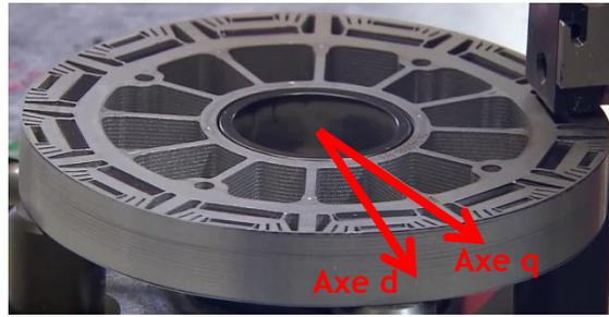
Figure 10 : Rotor du moteur de la BMW i3 en cours d'assemblage, source [17]
