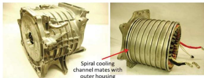
Figure 12 : Refroidissement du moteur de la BMW i3, source [18]
