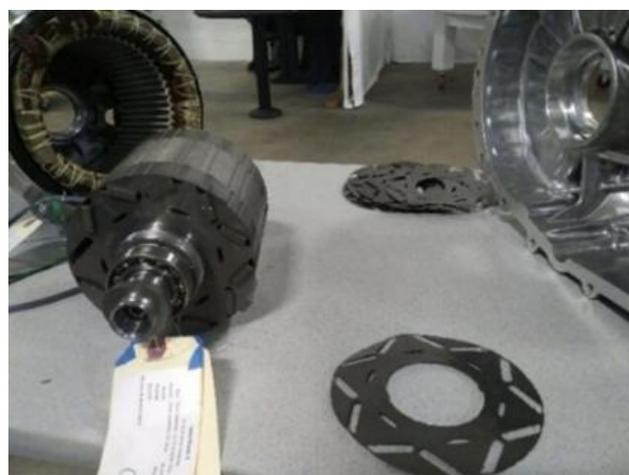
Figure 9 : Moteur à aimants de la Tesla model 3, source [15]
