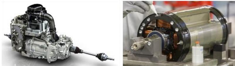
Figure 31 : Groupe motopropulseur Renault 5A Gen3, source [37], et rotor bobiné 4 pôles
