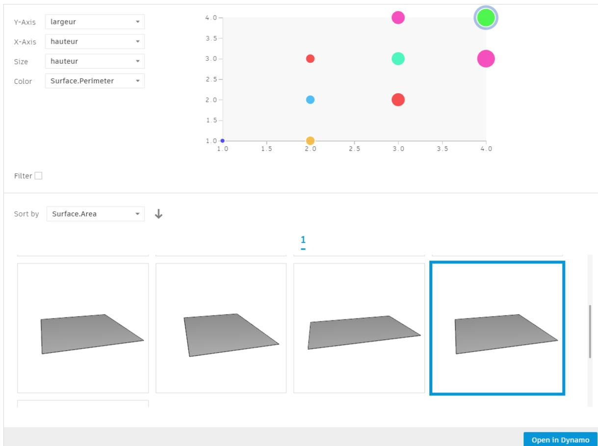
La solution optimisée est identifiée par le logiciel : la configuration en carré de 4m x 4m précédemment obtenue.
