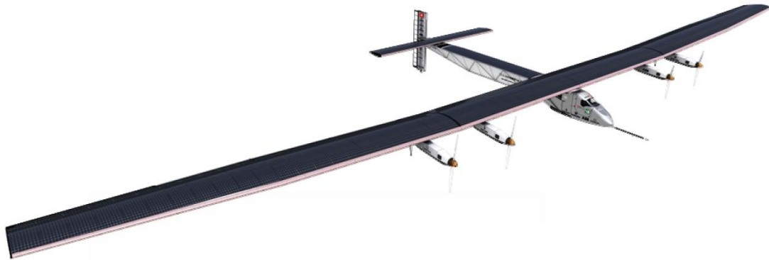
Figure 66 : Solar Impulse II, 270 m 2 de cellules PV silicium monocristallin 135 \mu , 633 kg d'accumulateurs eu lithium-polymère (260 Wh/kg), source [31]
