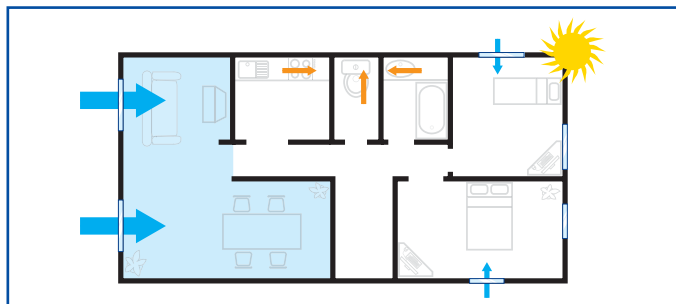
Occupation de jour : les entrées d'air se ferment en chambre et s'ouvrent plus en séjour.
