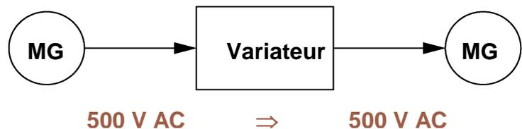
En outre, le variateur fournit le courant alternatif provenant de l'alimentation MG1 au courant alternatif de MG2. L'unité de commande électronique ECU HV transmet le signal au transistor d'alimentation interne au variateur à des fins de commutation de phase U, V, W de MG1, MG2 de manière à exciter MG1 et MG2.
