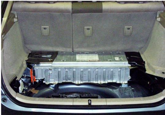
Le système THS-II a adopté des batteries étanches hydrure de métal-nickel (Ni-MH) pour la batterie HV. Cette batterie HV possède des caractéristiques une densité à haute puissance, elle est légère et possède une remarquable longévité spécifiquement conçue aux caractéristiques du système THS-II.
