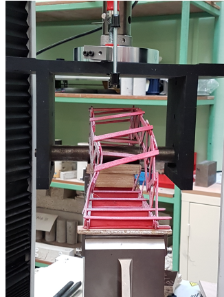
FIGURE 3.5 – Flambage à la base de l’arc
