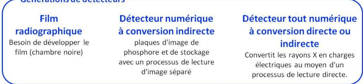
Figure 2 : Principe de la radiographie par rayons X et évolution des détecteurs + lecteurs, source poumon [2]
