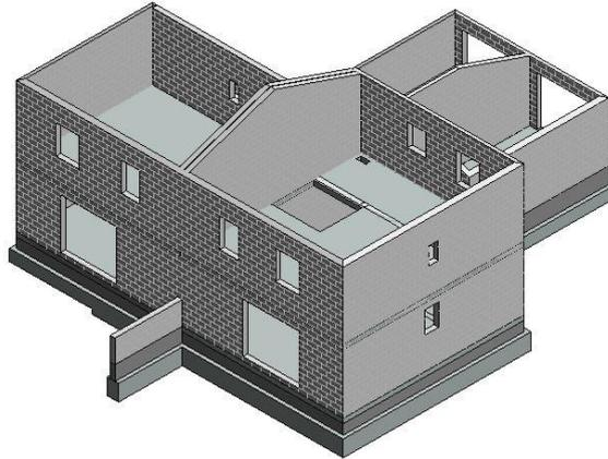
A partir du dossier des plans de coffrage, réaliser la maquette numérique des logements. Vous définirez précisément les éléments de structure (poutrelles, mur en BBM, béton armé,..) à l'aide des familles REVIT
