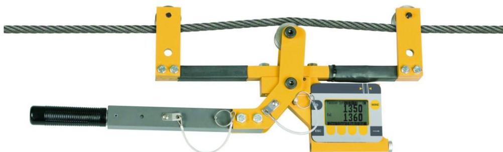
Figure 18 : Tensiomètre permettant de mesurer la tension interne d'un câble, source BM Engineering
