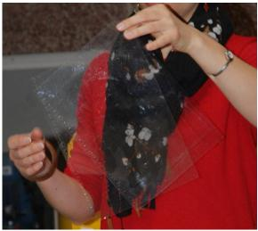
Figure 1 : Mise en évidence des forces capillaires collant deux feuilles plastique avec un peu d'eau
