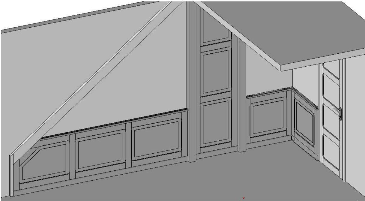
L'ensemble des parements est réalisé en MDF. Une finition soignée sera exigée. Une peinture sera appliquée ultérieurement.
