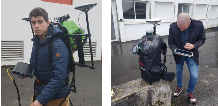
Figure 4-7 –ROBIN Mobile-mapping-système (à gauche) et LEICA Pegasus Backpack (à droite)
