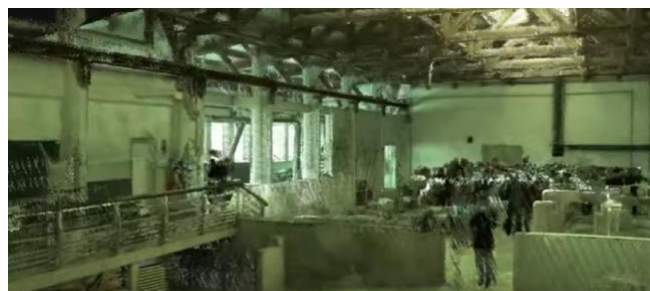
Figure 4-11 – Nuage de points réalisé dans l'atelier de maçonnerie ( https://youtu.be/p9OIeyxxFLY )
