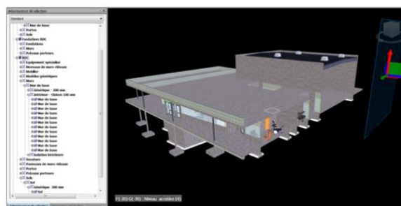
Figure 8-10 – Exemple d'intégration sous Naviswork pour analyse des métrés et visualisation du phasage global de chantier
