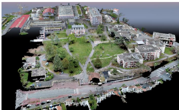
Figure 4-5 –Nuage de points obtenu après traitement des images.
