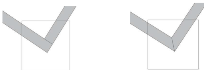
Figure 8-17 – Exemple de type de jonction entre voiles
