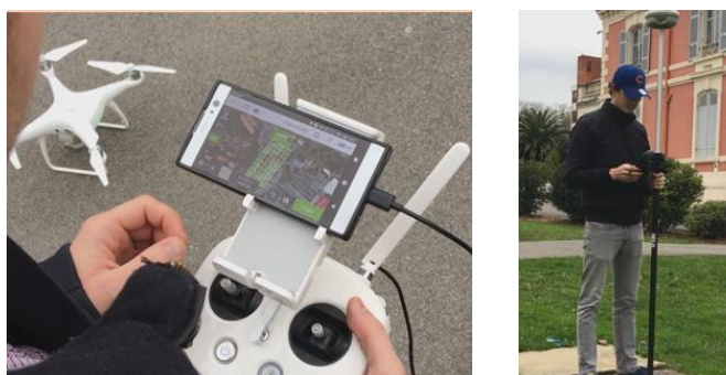
Figure 4-4 –Programmation du vol sur PIX4D Capture (à gauche) et Relevé GNSS des cibles (à droite)
