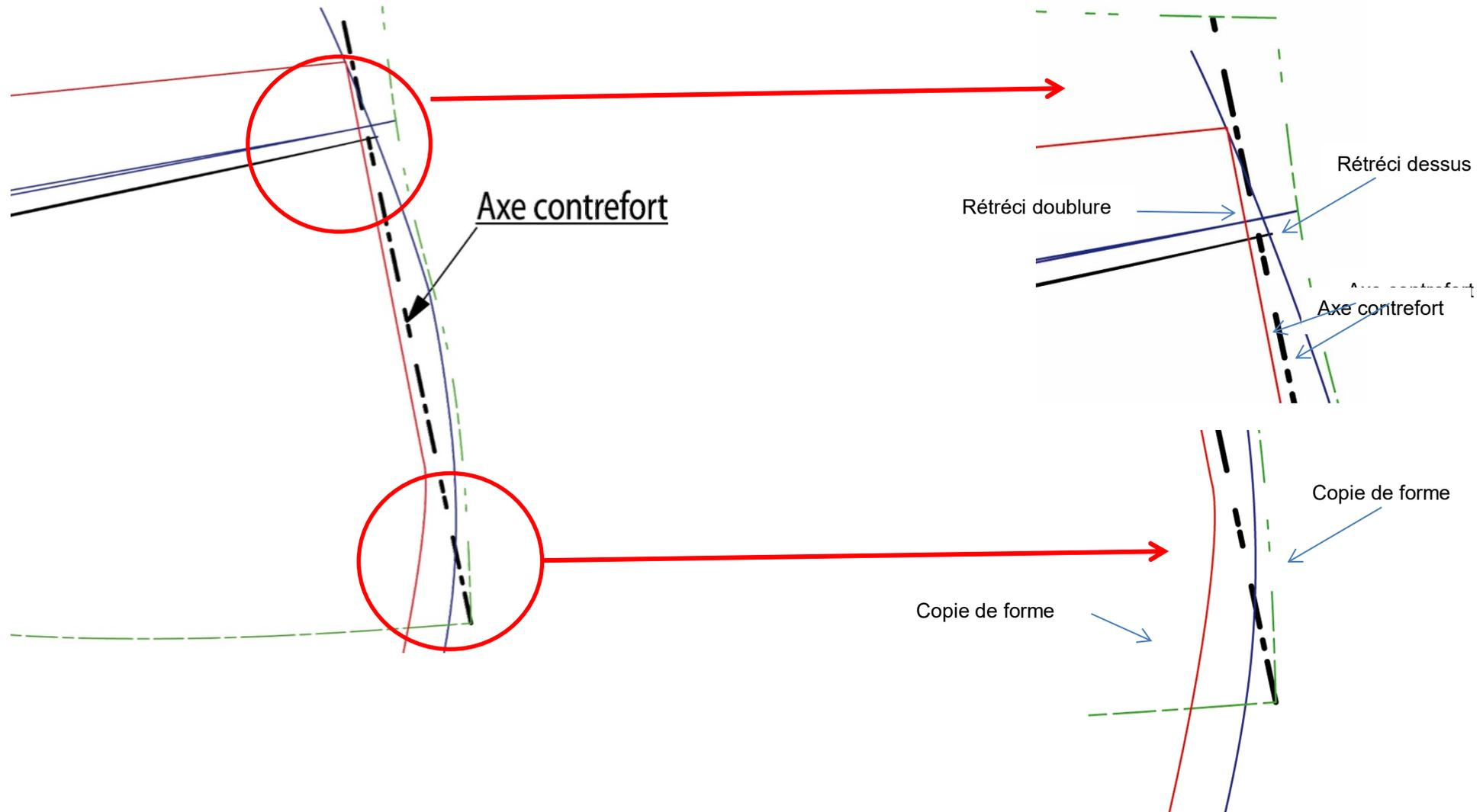
**NOTA :** L'axe de symétrie du contrefort est construit entre les rétrécis de la tige (dessus et doublure) et l'angle inférieur de la copie de forme.
