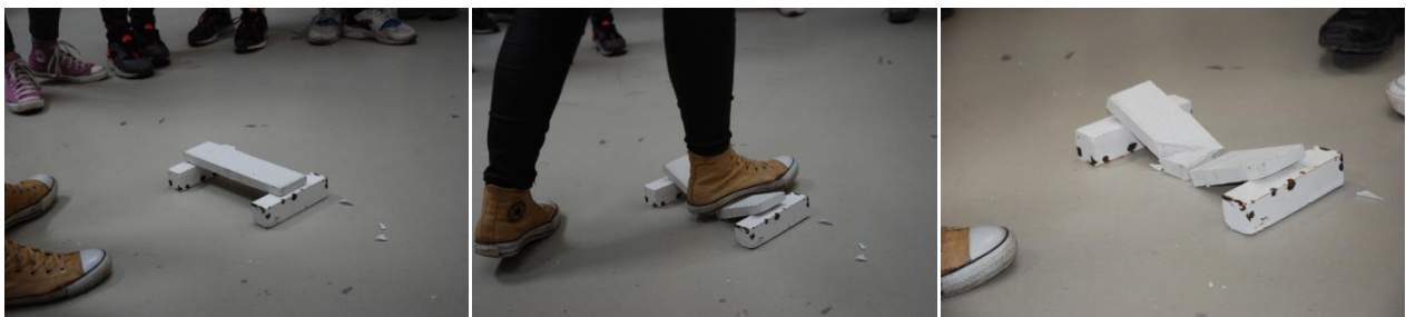
Figure 5 : Essai de flexion d'une éprouvette en béton
