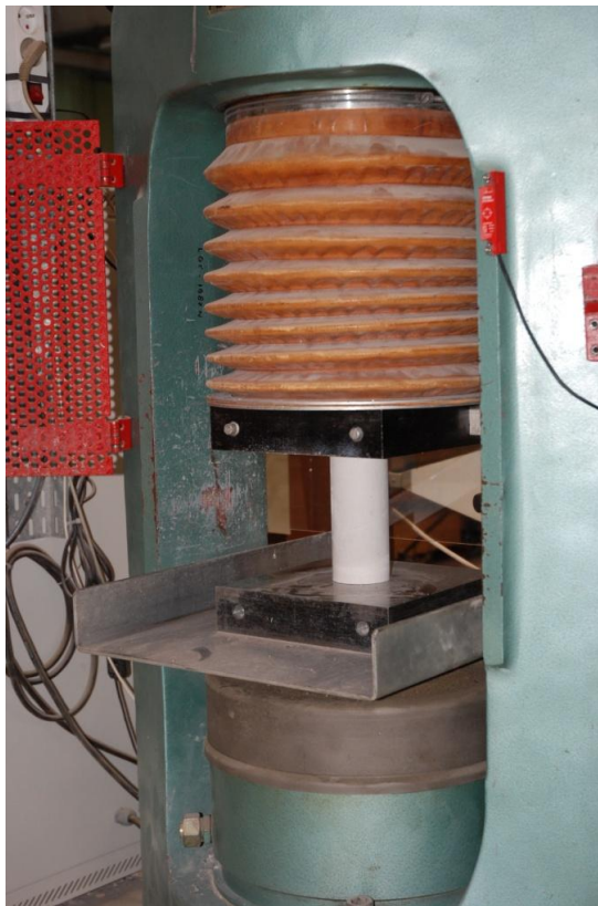
Figure 3 : Essai de compression sur une éprouvette en BFUP : avant/après
