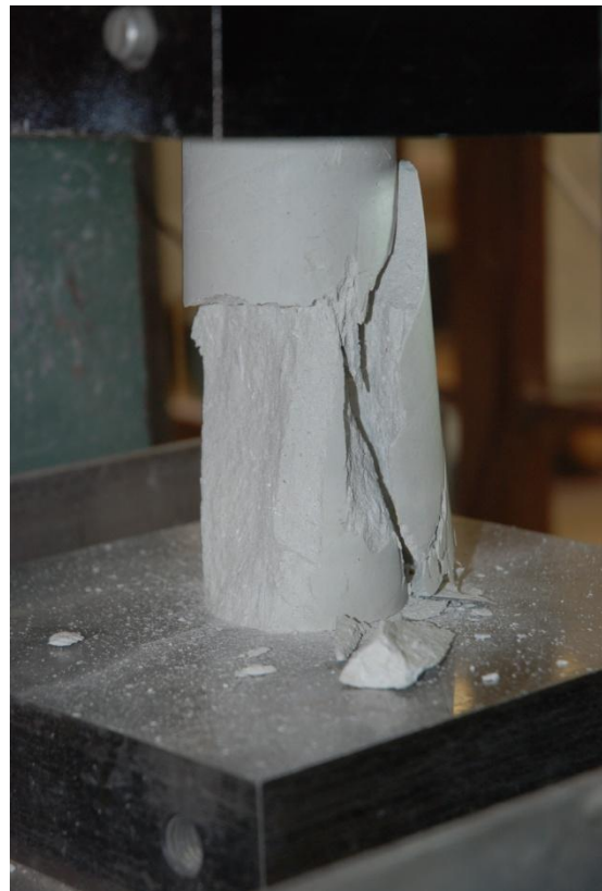
Figure 3 : Essai de compression sur une éprouvette en BFUP : avant/après
