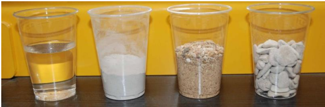
Figure 1 : Échantillons présentant les constituants d'un béton ordinaire : eau, ciment, sable et granulats
