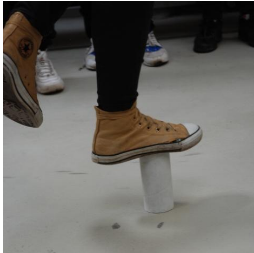
Figure 2 : L'éprouvette en béton supporte la masse d'une adulte
