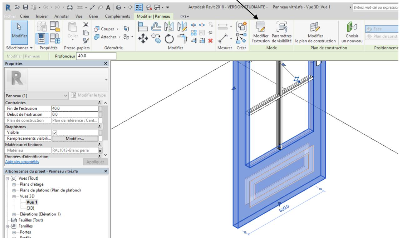
Il apparaît un contour rose, cliquer sur le trait du bas, une cote apparaît modifier la en tapant 370
