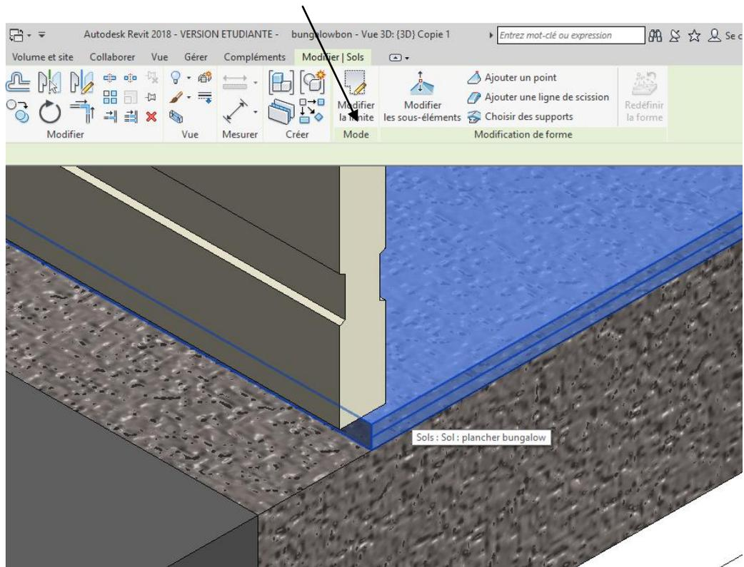
Un contour rose apparaît, placer vous dans le plan du RDC et modifier la limite
