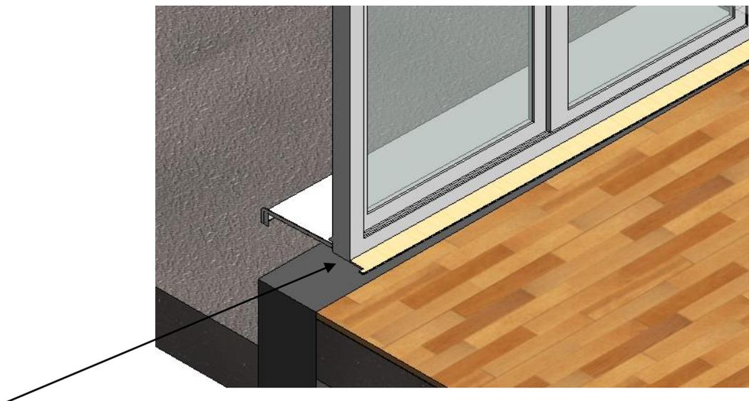
On voit apparaître une tablette bois qui n'a pas lieu d'être pour une porte fenêtre. On va la supprimer. De même la bavette extérieure obligatoire pour les fenêtres ne l'est pas pour une porte
