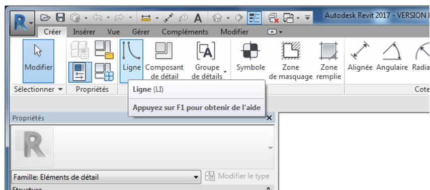
Dans la nouvelle fenêtre utiliser les commandes lignes et arc pour créer un profil plinthe de 10 mm d'épaisseur hauteur contre mur de 60 hauteur intérieure de 50 et un raccordement en arc de cercle de rayon 10 mm
