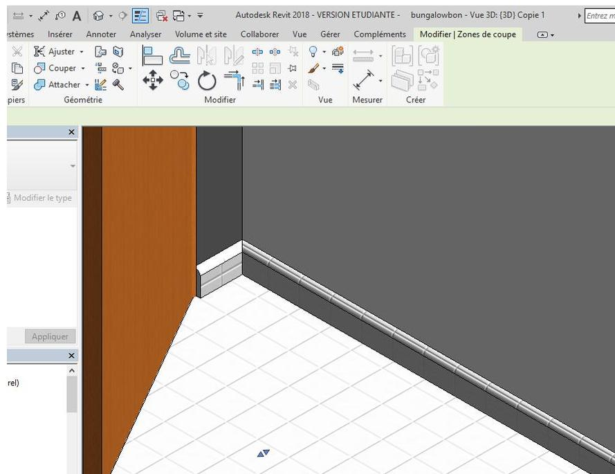
Nous allons maintenant créer les plinthes du salon en utilisant une autre technique **Le mur en relief**.
