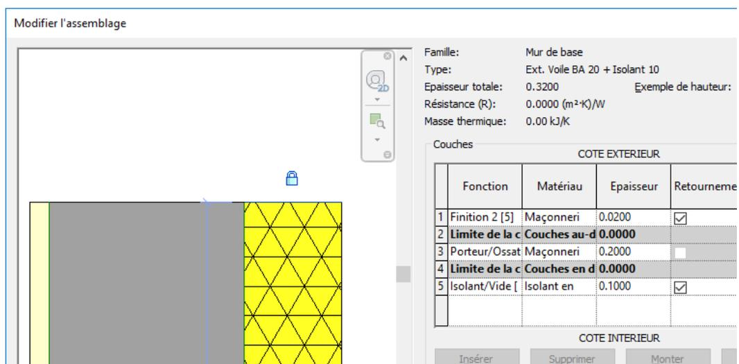
Faites un zoom sur la partie supérieure du mur, cliquer sur le haut de l'isolant, un cadenas apparaît cliquer dessus pour le déverrouiller
