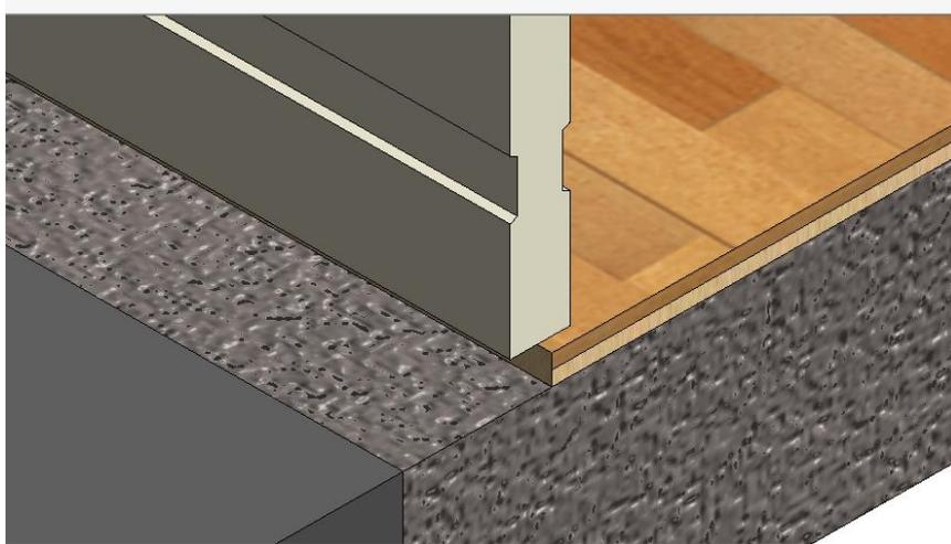
Nous allons maintenant arranger la liaison, en arrêtant le parquet à la limite intérieure et en créant un seuil de porte
