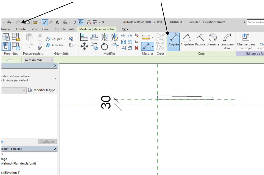
Cliquer sur la cotation nous allons créer un paramètre, cliquer sur cette icône à coté de libellé
