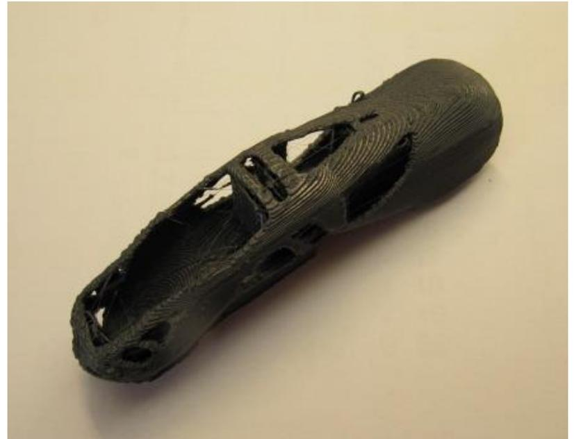
Le critère initial doit être bien sur validé : résistance mécanique sous l'effet d'un chargement vertical de 30 N en bout d'attelle : déplacement maxi de 1 mm (au point relevé sur maquette).
