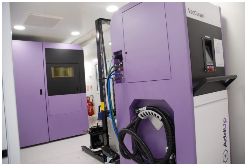
Figure 17 : Machine à solidification de poudre sous l'action d'une source d'énergie, source [3]
