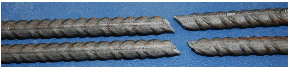
Figure 20 : Barres après rupture lors de l'essai de traction
