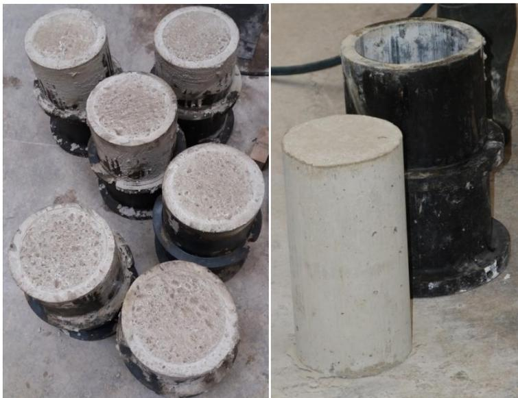
Figure 1 : Les six éprouvettes de béton après durcissement et une des éprouvettes juste démoulée
