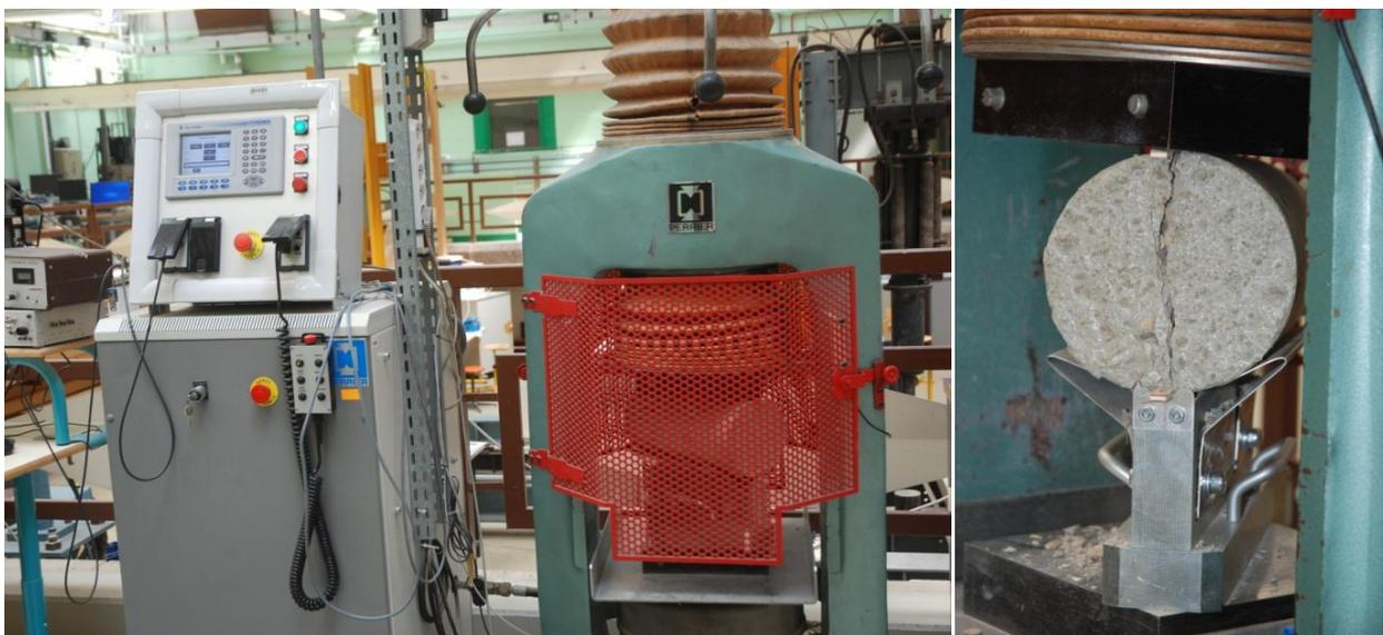
Figure 5 : Essai de fendage et éprouvette fendue
