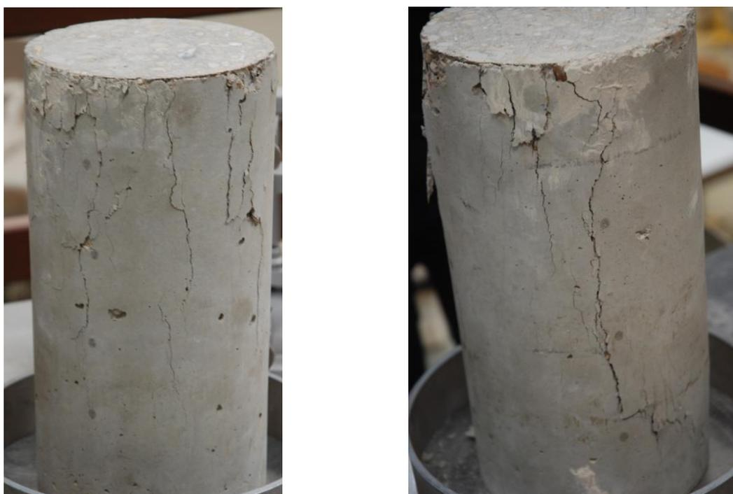
Figure 15 : Fissures des surfaces latérales des éprouvettes après essais de compression
