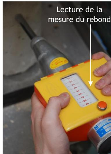
Figure 7 : Essai de dureté à l'aide du scléromètre
