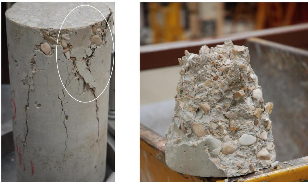
Figure 17 : Cône de fissuration et rupture conique de l'éprouvette
