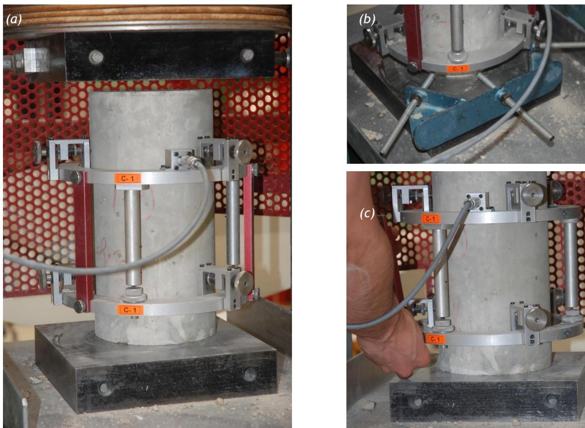
Figure 12 : (a) Installation éprouvette et cage sur la machine, (b) centrage et (c) démontage des entretoises
