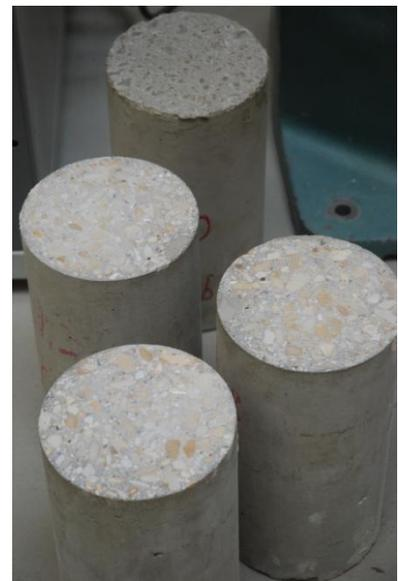
Figure 2 : Trois éprouvettes surfacées pour les essais de compression
