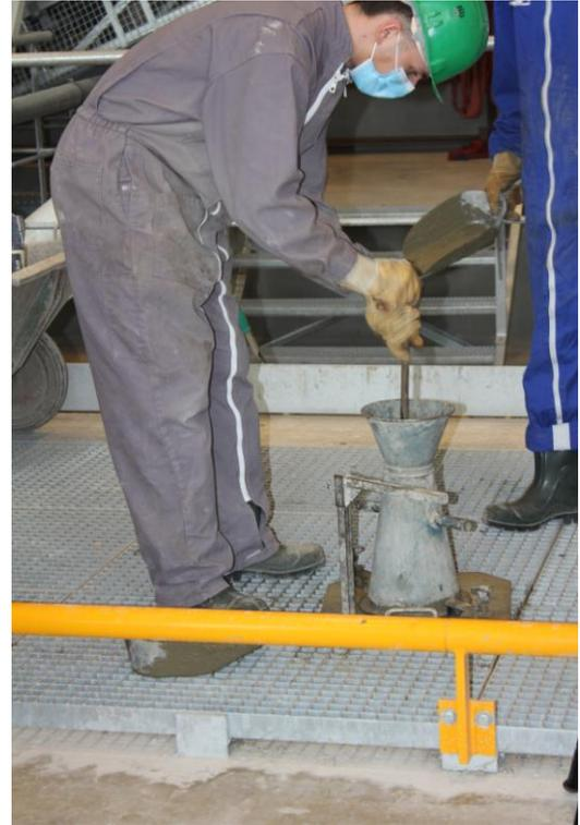
Figure 19 : Remplissage en 3 fois du cône d'Abrams, et piquage entre chaque couche
