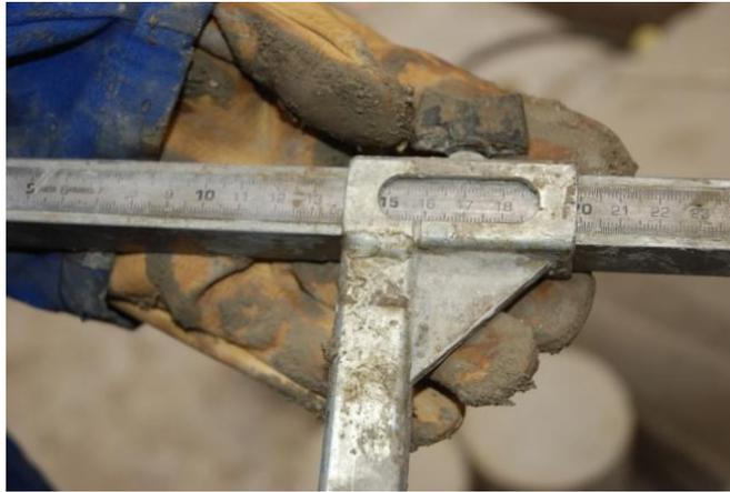
Figure 21 : Mesure de l'affaissement du béton frais
