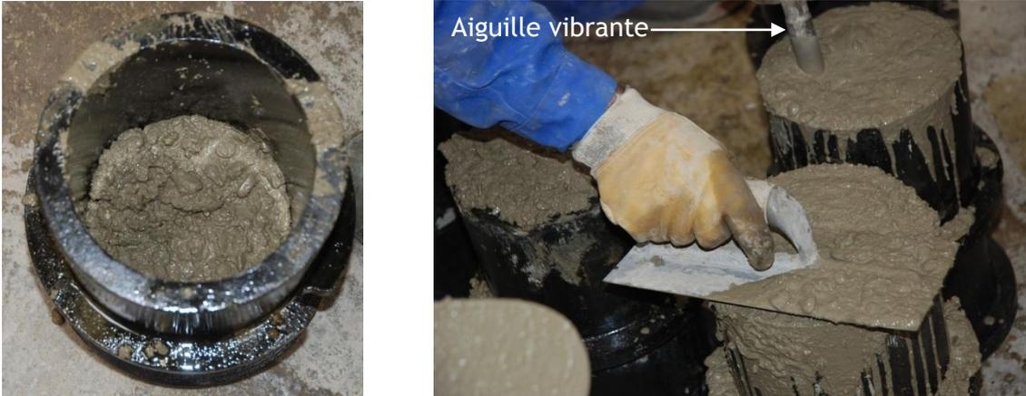
Figure 34 : Réalisation des six éprouvettes
