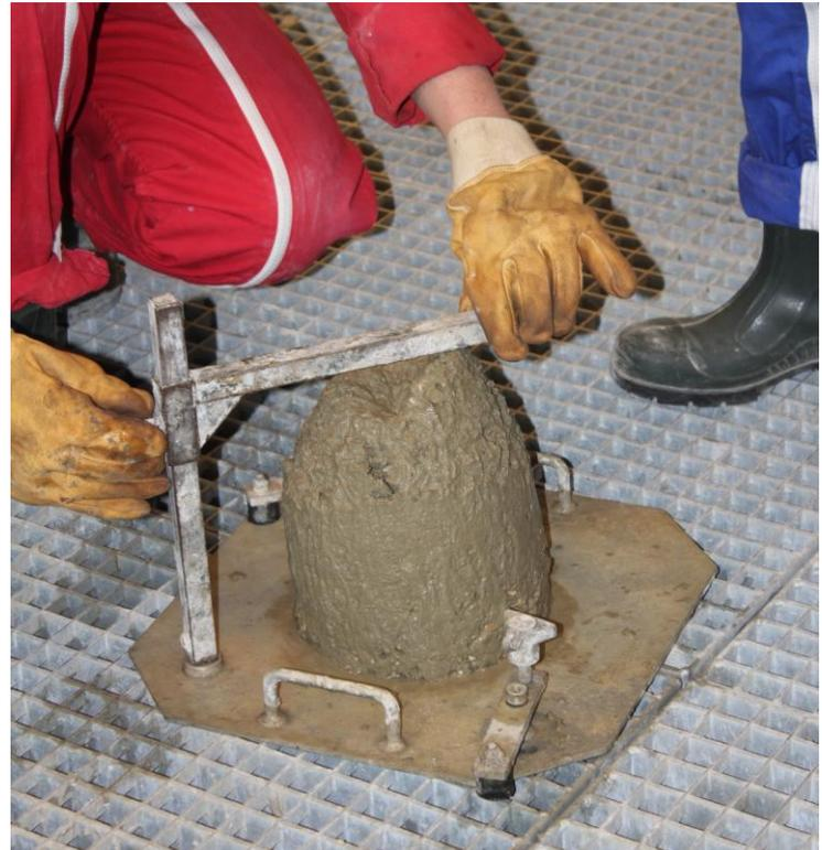
Figure 20 : Cône d'Abrams arasé puis soulevé, affaissement du béton frais
