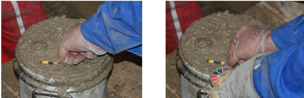
Figure 26 : Estimation du pH du béton
