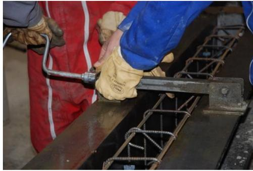
Figure 28 : Fermeture du moule
