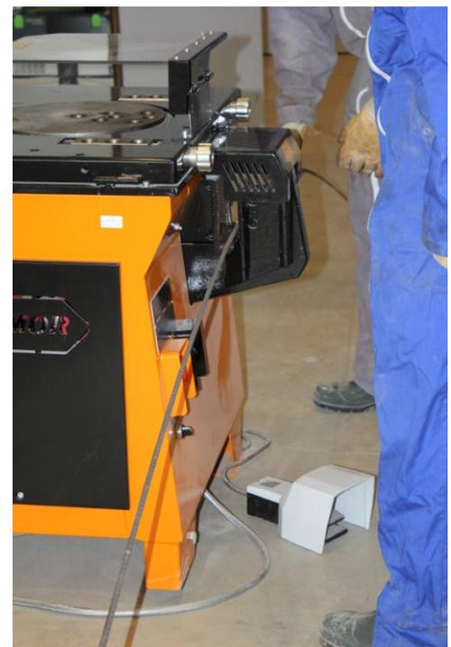
barre à l'aide de mandrins selon un rayon donné (figure 6). Il faut veiller à réaliser les deux cintrages d'une barre dans le même plan !
