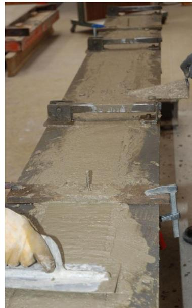
Figure 32 : Dépôt de la seconde couche et poutre vibrée
