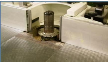
La machine se règle en profondeur
