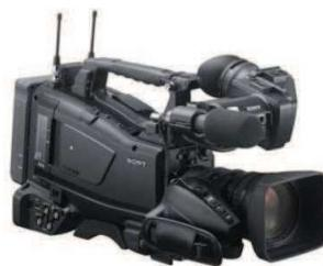
Caméra d'épaule avancée XDCAM dotée de trois capteurs CMOS Exmor® 2/3"
