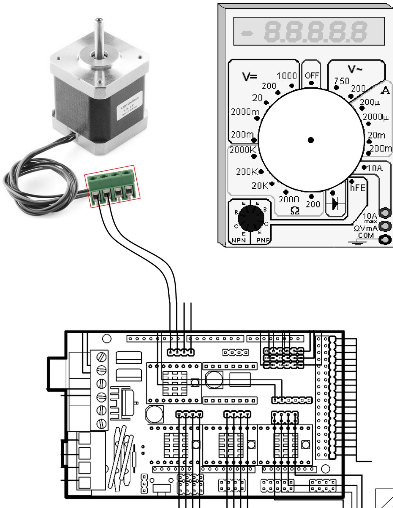
On mesure également la résistance de l'une des bobines du moteur. Le multimètre étant réglé sur le calibre **20K Ω**, son affichage est celui-ci :
