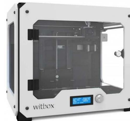
Cette imprimante permet par usinage additif (dépôt de matière par couche) la réalisation de pièces en différentes matières, que ce soit dans un but professionnel ou ludique. Le modèle présenté ici, par son coût, sa taille et sa précision est plutôt destiné à des particuliers.
