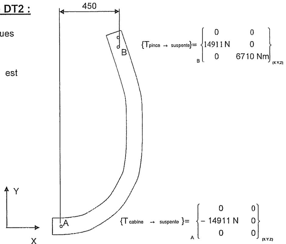
**Simulation de la suspente en résistances des matériaux**
