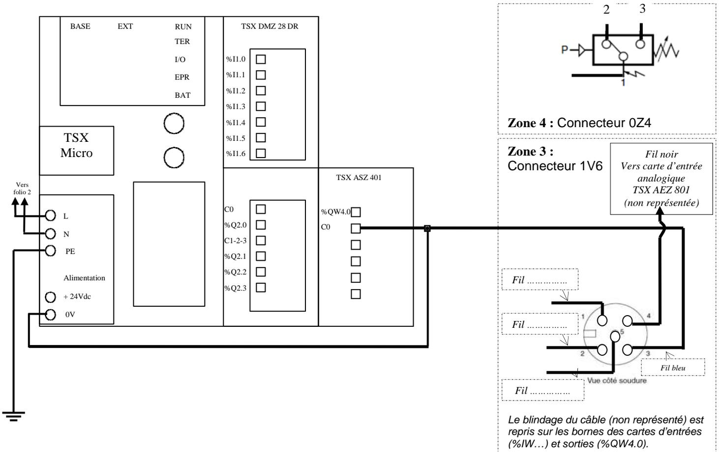
**Q3.4 :** Sur le schéma ci-dessus, câbler sur la carte des entrées de l'automate TSX DMZ 28DR, le connecteur électrique du pressostat 0Z4 (zone 4), vous utiliserez le contact NO et l'entrée %I1.6 :
