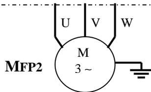
**Q4.4 :** Compléter le schéma de câblage de la plaque à borne du moteur MFP2 dans la zone 7 (représenter les barrettes et repérer les bornes) :
