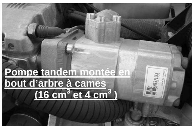
**Pompe tandem montée en bout d'arbre à cames**
