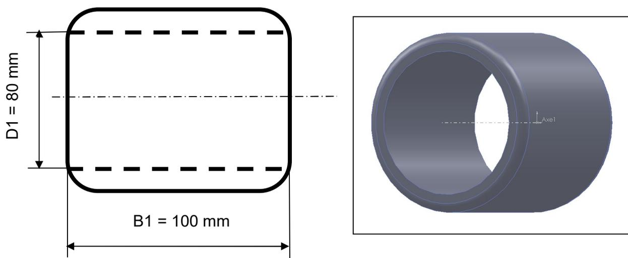
On prévoit une durée de vie des bagues de 5 ans pour un fonctionnement de la machine 24h/24h durant 344 jours par an.
