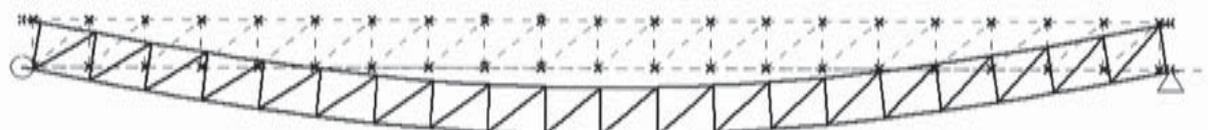
**Figure 5 – Déformation du treillis**
