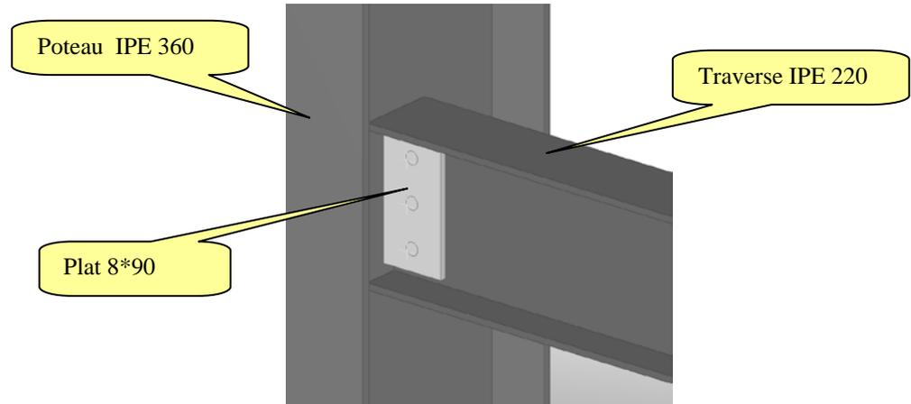
L'attache est représentée sur la figure ci-contre. Un effort  $F$  calculé à l' ELU ( 25kN) est situé au droit des boulons.
