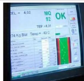
L'analyse thermique consiste à enregistrer la courbe de refroidissement d'une fonte en cours de solidification (dans un petit godet en sable à prise chimique) et à interpréter en automatique cette courbe pour en déduire des informations sur sa composition et les caractéristiques mécaniques attendues.
