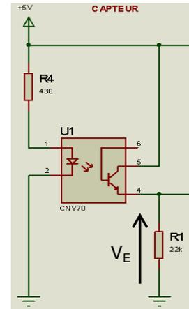
Le faisceau lumineux de la diode émettrice est réfléchi par une barre blanche ou absorbé par une barre noire. Lorsque la base du transistor est éclairée par la diode émettrice le phototransistor est équivalent à un interrupteur fermé entre l'émetteur et le collecteur. Lorsque la base n'est pas éclairée, cela équivaut à un interrupteur ouvert.
