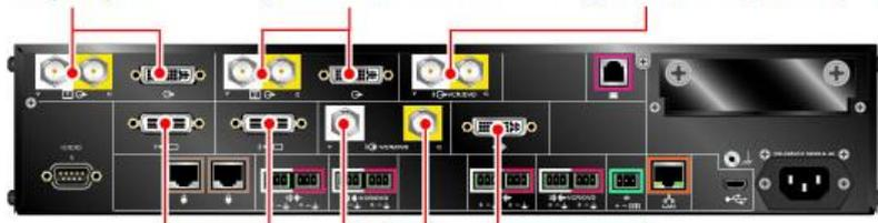
Entrées vidéo 1 et 2 : HDCI pour les caméras 1 et 2      Entrée vidéo 3 : BNC pour la diffusion du contenu par le magnétoscope/lecteur DVD pendant les appels      Entrée vidéo 4 : DVI pour la diffusion du contenu à partir d'un ordinateur pendant les appels
