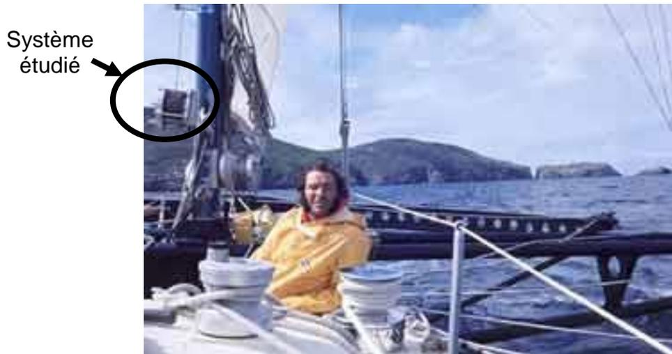
L'enrouleur de drisse Goiot de catégorie 70, possède un tambour dont le diamètre est au moins 15 fois celui du câble qu'il reçoit. Cela permet de ne pas déformer et fatiguer la drisse en acier inoxydable.
