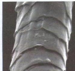
Fig. 4 - La structure en écailles de la laine favorise son feutrage (photo au microscope électronique à balayage IFTH-Lyon)
