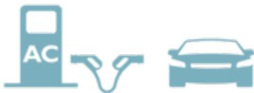
Dans le mode de charge 3, le dispositif de protection contre le courant résiduel est déjà intégré dans la station de charge. Celle-ci assure la communication avec le véhicule, permettant ainsi de le recharger avec jusqu'à 63 A triphasés. Dans le cas de charge B, le connecteur du câble de charge enfichable est branché dans l'entrée du véhicule, tandis que le connecteur de l'infrastructure est raccordé à la borne de charge de la station de charge.
