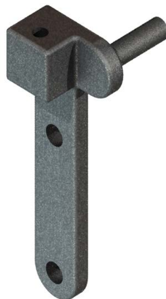
Fig 5 : La représentation du support porte rotule obtenue par moulage.
