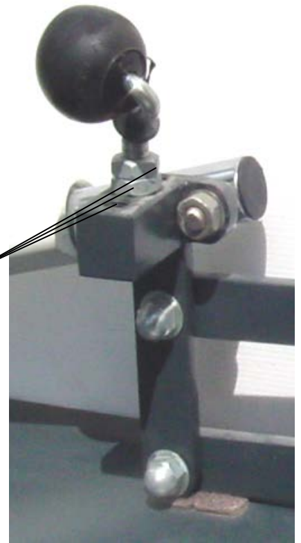
Fig 4 : La liaison rotule-support-vérin
