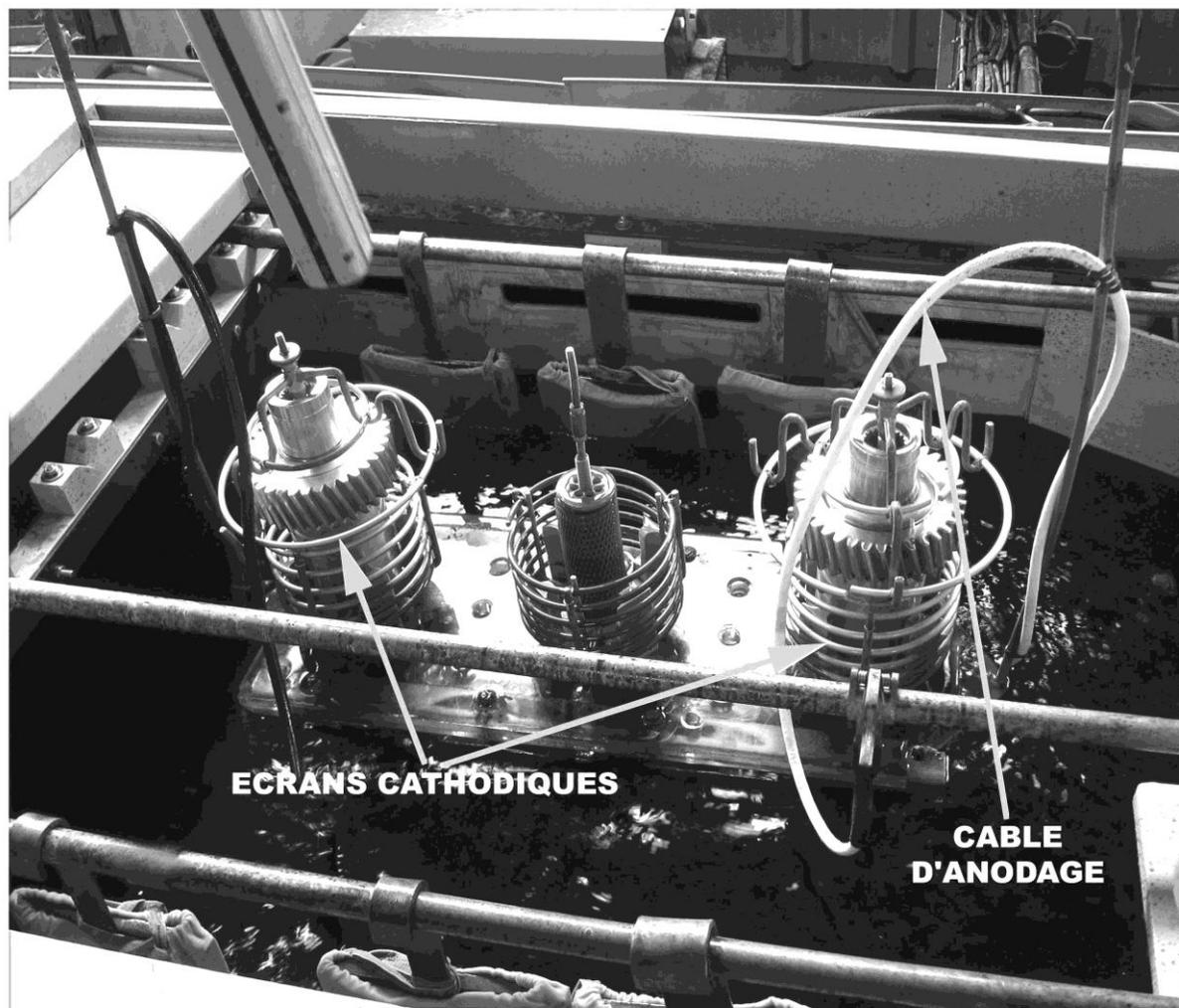
Le traitement qui va débuter est le cuivrage de charge. On veut assurer une bonne répartition du dépôt de cuivre dans la partie intérieure du pignon et réduire l'épaisseur de cuivre dans les zones extérieures qui devront être décuivrées par la suite. Pour ce faire, il est prévu un anodage interne, relié à un générateur annexe par un câble d'anodage et des écrans cathodiques, encore appelés « voleurs de courant ».
