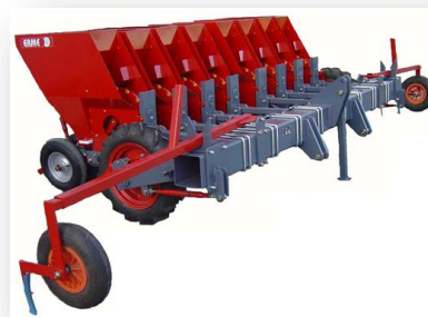
Planteuse mécanique rang double
