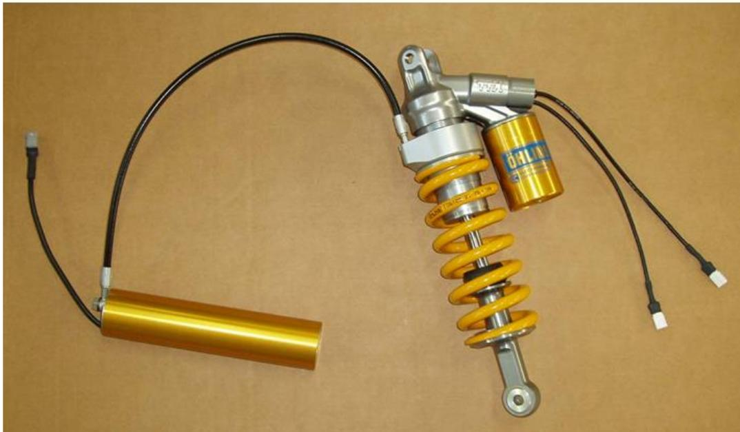
A droite, les câbles qui sortent du corps de l'amortisseur alimentent les actionneurs des freins hydrauliques
