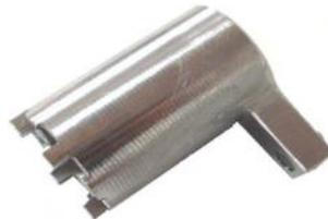
12 - Clé pour montage capteur de carburant
