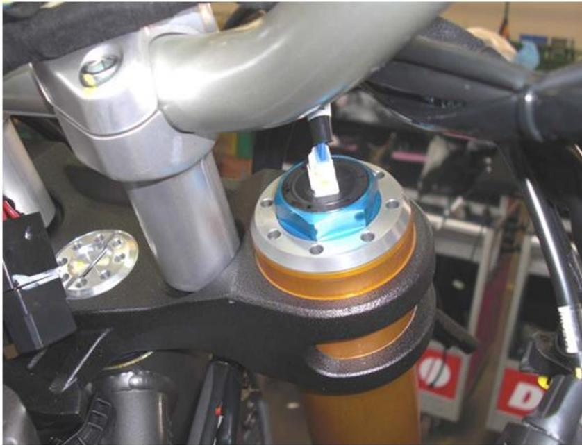
Extrémité supérieure du tube droit de la fourche dans lequel est inséré le moteur électrique pas à pas qui agit sur le frein hydraulique en extension
