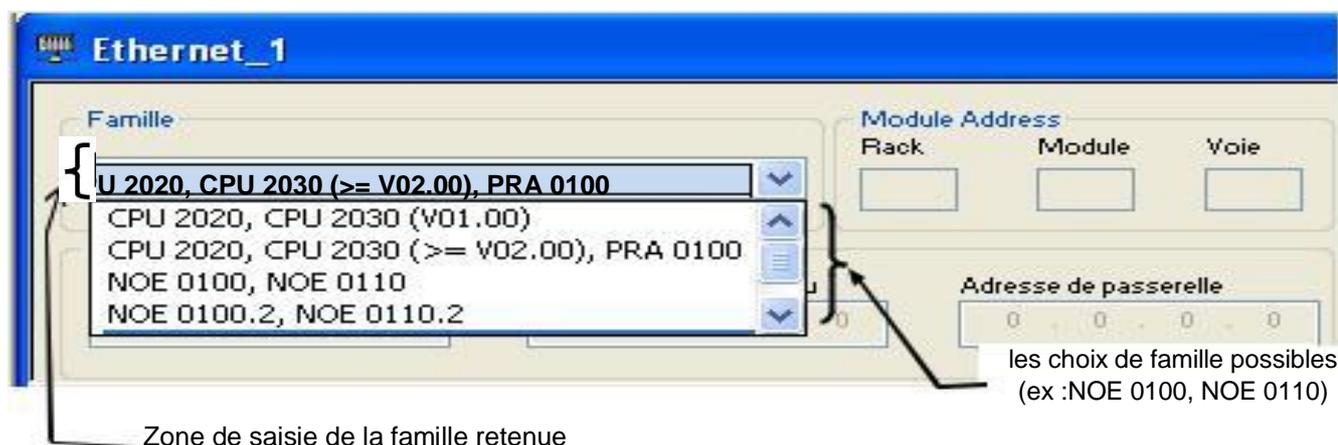
**F3.3 - Renseigner l'adresse IP et le masque de sous réseau du port de communication Ethernet du processeur de l'automate.**
