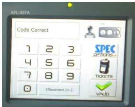
Lorsque l'utilisateur touche l'écran tactile avec la pointe d'un stylet (ou d'un doigt), le contrôleur de la dalle détermine la coordonnées (X,Y) sélectionnée, puis l'information est transmise via un bus SPI au processeur principal du pupitre afin d'y être traitée.
