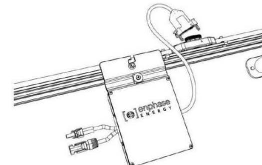
Pour installer le câble, il suffit de le dérouler, puis de le couper à la longueur requise. Une des extrémités est raccordée directement dans la boîte de jonction de la branche AC. L'autre extrémité est protégée des agressions externes par l'utilisation d'un embout de terminaison Enphase. Les connecteurs de câble M215 AC sont alors branchés aux connecteurs espacés de manière régulière comme illustré.
