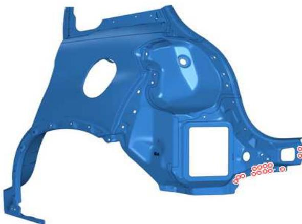
Tracer puis percer au diamètre 8 mm pour un soudage ultérieur par points bouchons MAG.
