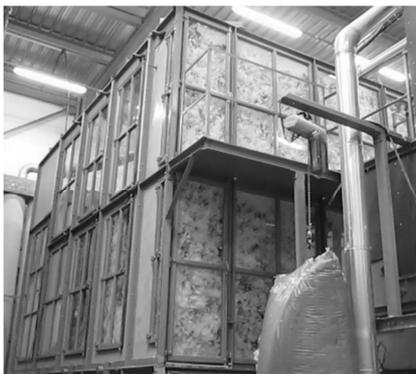
Partie basse de la machine : la plume est triée et stockée en chambres
