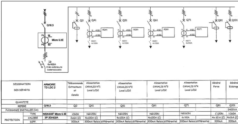
**B4.1 Paramétrer le relais différentiel RD 71 afin d'obtenir un déclenchement instantané de Q71 (fonctionnement en sécurité positive avec réarmement manuel)**
