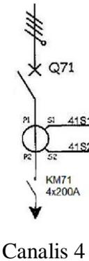
Lors de la mise en service du Canalis n°4, le disjoncteur Q71 se déclenche de manière systématique.
