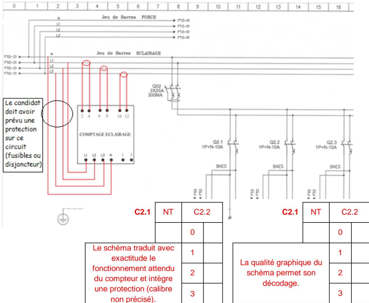
C2.2 **Compléter** le tableau suivant afin de prévoir le matériel de raccordement du circuit comptage sur le jeu de barres. Celui-ci sera réalisé en conducteurs souples de 1 mm<sup>2</sup>.
