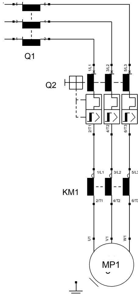
**QB1.1.** Choisir le calibre et le modèle du disjoncteur magnétothermique Q2 dans la gamme GV2 ME dont les caractéristiques sont données document **DT3**.
